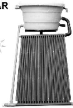
COLETOR SOLAR FEITO COM TUBOS DE PVC
